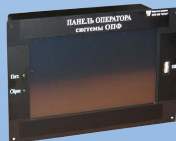
Система определения поврежденного фидера
