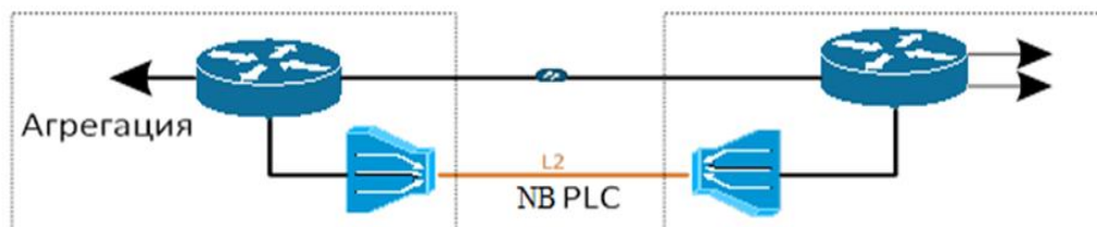
Рисунок 2.11.5.8 - Участок сети с использованием PLC
