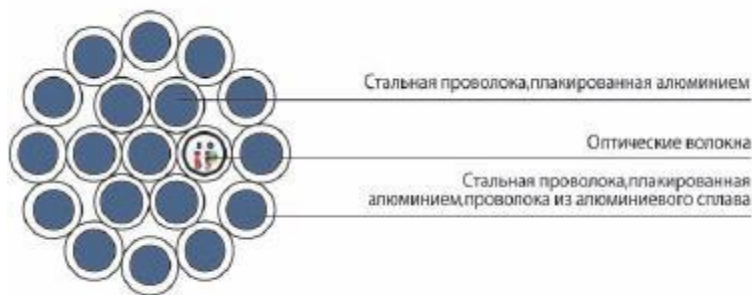
Рисунок 2.11.6.3.2 - Пример оптического кабеля, встроенного в фазный провод
