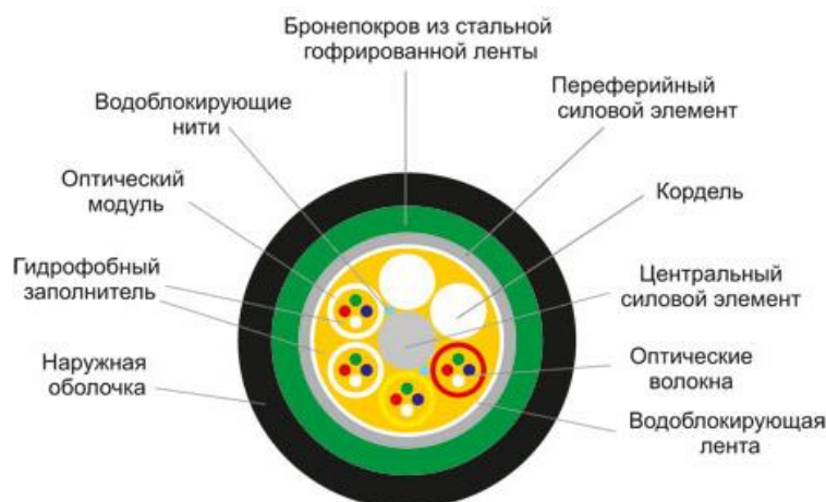
Рисунок 2.11.6.6 - Пример конструкции ВОК для прокладки в зданиях
